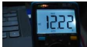
Gambar 13. Penghitungan Tegangan Avometer
