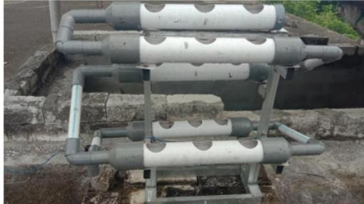
Gambar 4 Instalasi Hidroponik DFT
