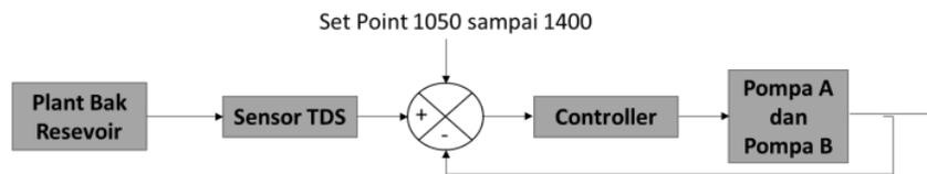
Gambar 2 diagram blok sistem kendali nilai TDS dalam sistem hidroponik
