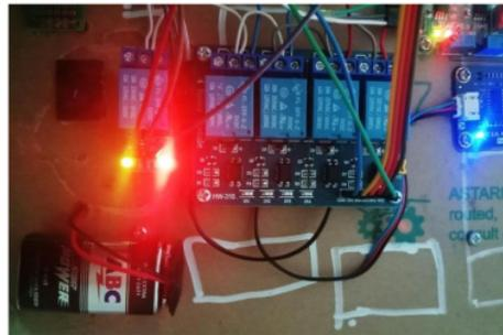
Gambar 5 Relay untuk pompa air baku menyala.
