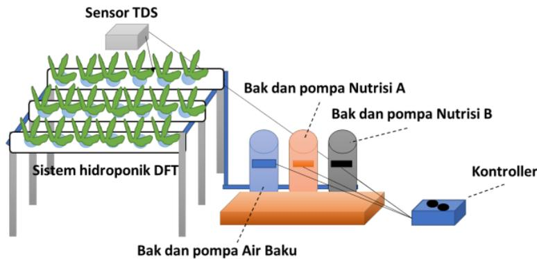
Gambar 3 Desain Sistem hidroponik
