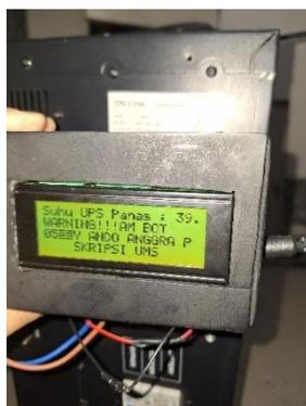
Gambar 11. Gambar Hasil Sensor Suhu
