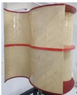
Gambar 1. Turbin Angin Sumbu Vertikal Ugrinsky
