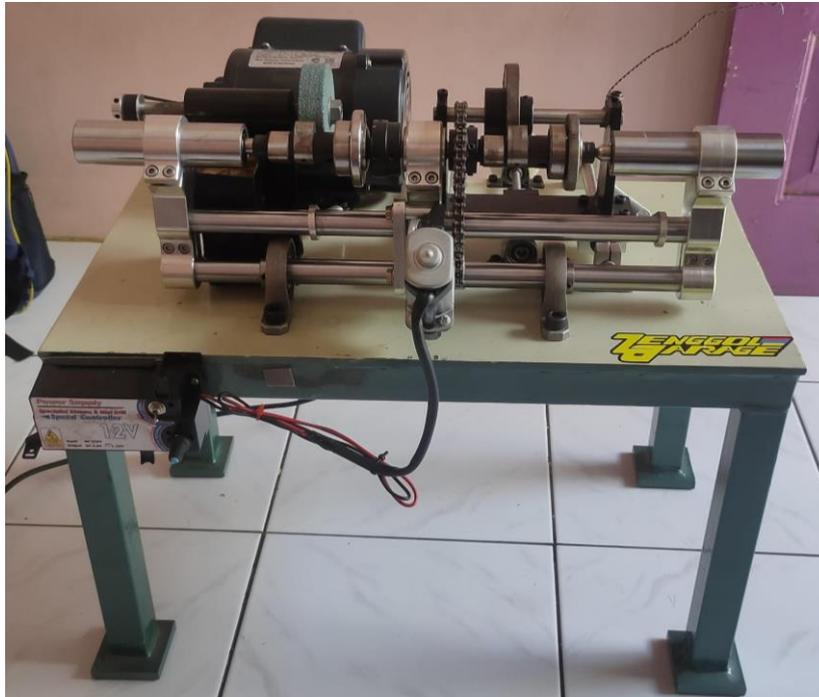
Gambar 7. Mesin gerinda penduplikat poros cam setelah proses pembuatan
