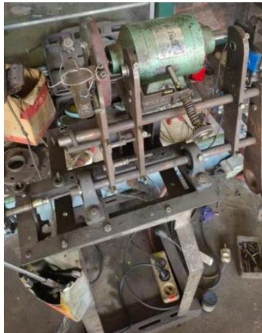
Gambar 5. Alat duplikat cam Bengkel Yuwana Motor
