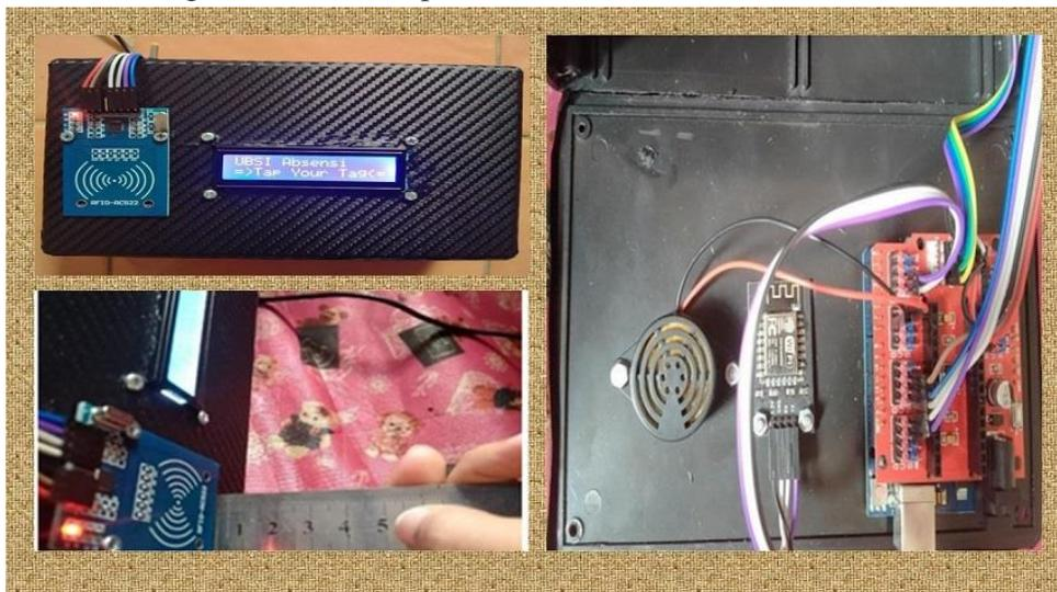
Gambar 10. Bentuk *Hardware* pada Sistem Pemantau Kehadiran Berbasis IoT
