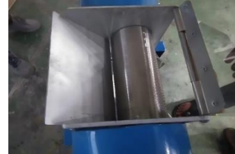
Gambar 10. perakitan kedua casing samping, mata pisau parut, casing tengah dan casing bawah
