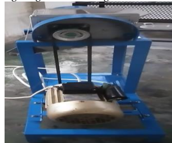
Gambar 11. Perakitan Kerangka dan penggerak
