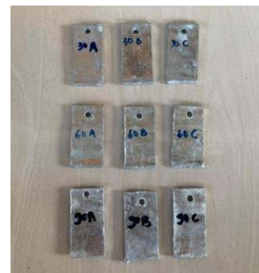
Gambar 2. Spesimen yang sudah dilakukan pelapisan galvanis dan diberi kode
