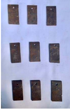
Gambar 1. Raw material menggunakan baja SS540 dengan ukuran tebal 3,4 mm x lebar 26 mm x panjang 54 mm.
