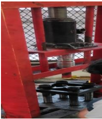
Gambar :Cetakan briket (sumber:dok.Pribadi)
