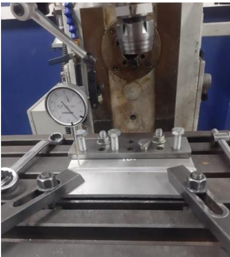
Gambar 2.4 Proses pengukuran kedalaman cacat permukaan
