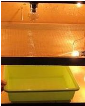
Gambar 1. Media air dalam nampan pada mesin tetas telur
