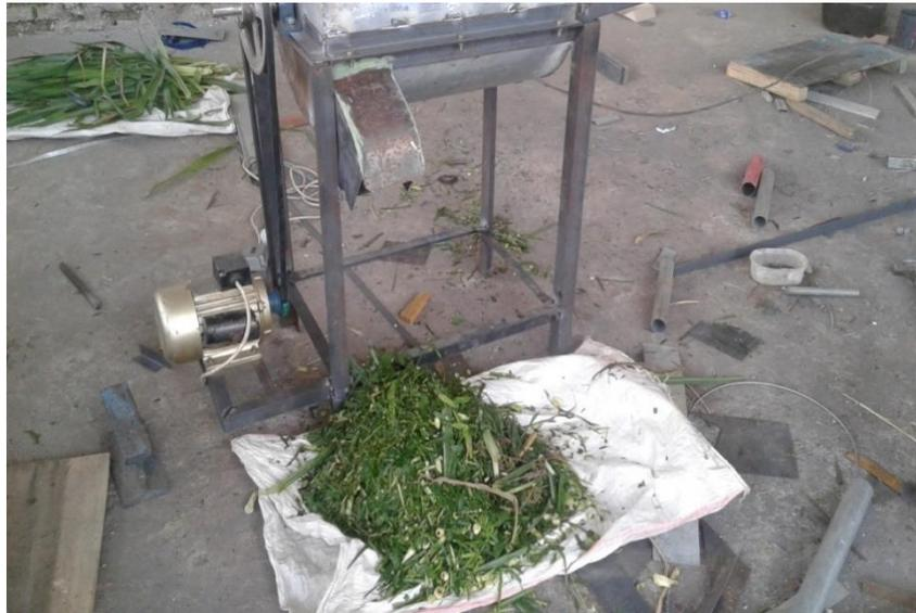
Gambar 7. Proses Uji Coba Pemetongan Rumput Gajahan
