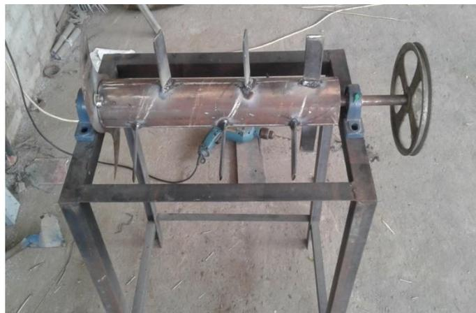
Gambar 5. Proses Pembuatan Screw Pendorong
