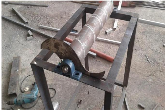
Gambar 4. Proses Pembuatan Rangka dan Penempatan Pisau Potong
