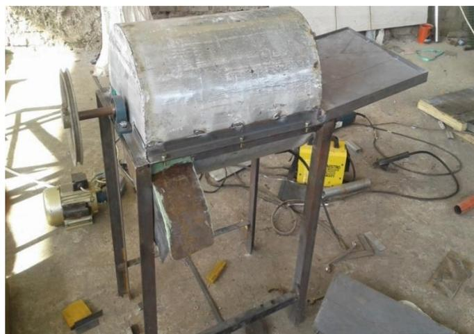
Gambar 6. Proses Pembuatan dan Perakitan Penutup Pencacah.
