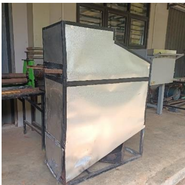
Gambar 4. Gambar alat insinerator beserta cerobongnya.
