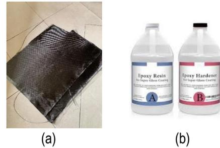
Gambar 1. Serat Karbon (a), Resin Epoksi dan Hardener (b)
